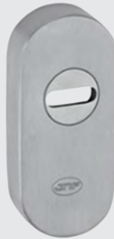
IN.04.33S DESCRIÇÃO: ESCUDETE DE SEGURANÇA PARA CILINDRO EUROPEU MATERIAL: AÇO INOXIDÁVEL - EN 1.4401
